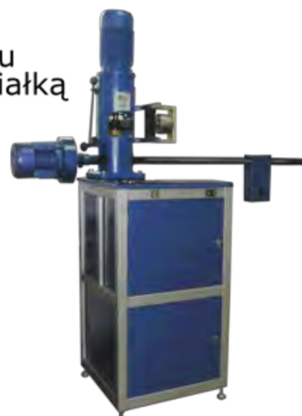
Rys. 4. Aparat czterokulowy T-02
