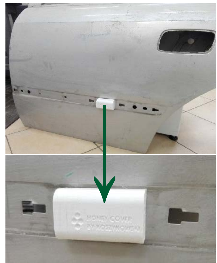
Rys. 5. Widok nakładki „HONEY COVER” zaprojektowanej i wykonanej w 3D
