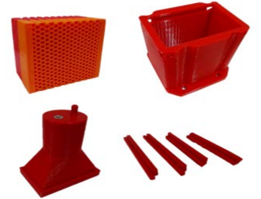
Rys. 7. Wydrukowane elementy wkładu energochłonnego
