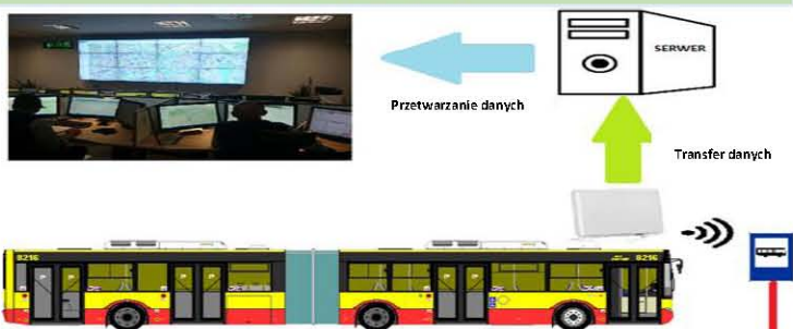
Rys. 2. Schemat przedstawiający relację autobus (czytnik) – przystanek (znacznik)
